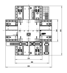
\*接口图纸为8英寸高真空电动精密二维位移台
