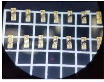
格物光学的增益芯片 (Gain chip) 系列产品, 是可以用作外腔半导体激光器光增益介质的半导体光元件。格物光学可以提供低反射率类型或高反射率类型作为垂直侧面侧的反射率。且可以供应Chip或COC类型的产品, 也可以根据客户需求封装成器件供货。
